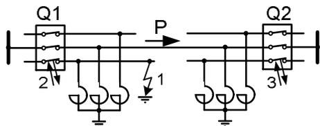
Рис.7. Схема опыта ОАПВ на ВЛ 750 кВ КАЭС-Череповец.
