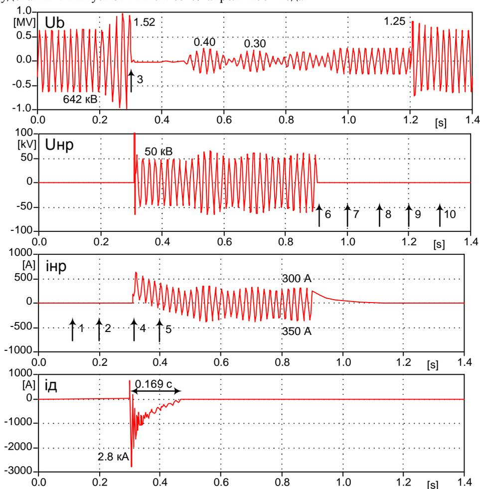
Рис.5. Результаты расчета ОАПВ на ВЛ 750 кВ в схеме рис.1,б по программе EMTP с использованием модели дуги.
