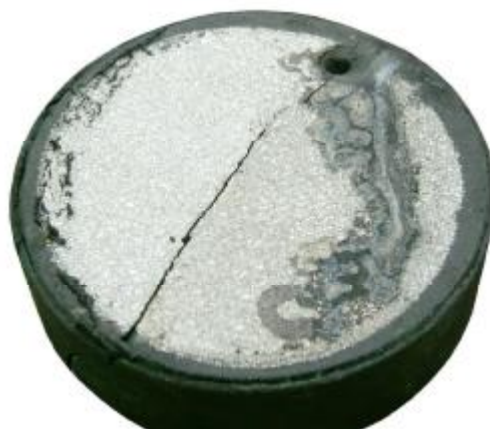
Рис.1. Фотография варистора, повредившегося вследствие прожега.
