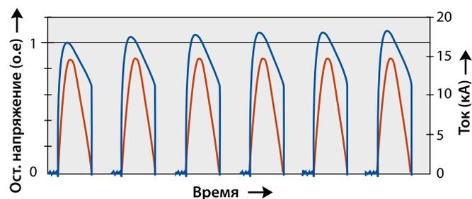
**Рис. 4.** Изменение резистивной составляющей тока через варистор, находящийся под действием наибольшего рабочего напряжения при температуре 115°C после приложения двух импульсов тока [2]
