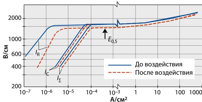
$I_{\Sigma}$  – полный ток через варистор;  $I_C$  и  $I_R$  – соответственно емкостная и резистивная составляющие полного тока [1];  $E_{0,5}$  – напряжение на варисторе при токе 0,5 мА.
