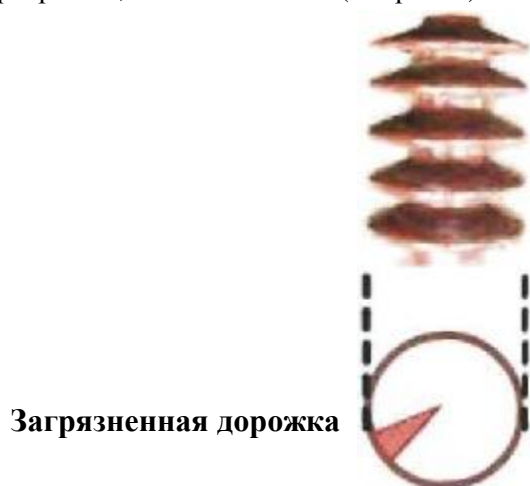
Рис. 2: значение распределения загрязнения по поверхности изолятора
