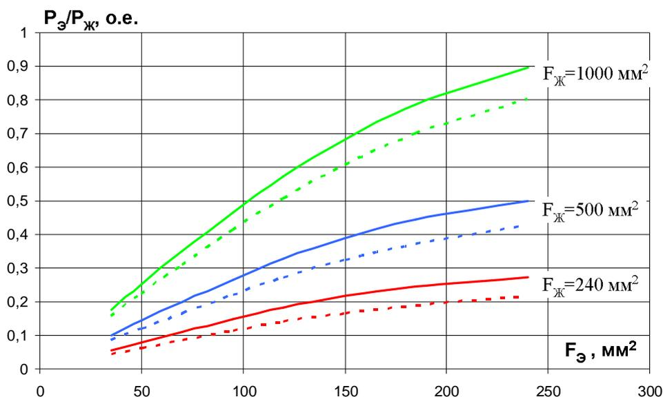
Рис.4. Источники потерь в кабеле 6-500 кВ произвольной длины, проложенном сомкнутым треугольником, в зависимости от сечений жилы  $F_{\text{ж}}$  и экрана  $F_{\text{э}}$ , заземленного по концам кабеля. Сплошная линия – кабель 10 кВ, пунктирная линия – кабель 110 кВ.
